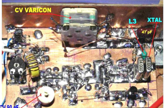
La solution pratique pour varier en fréquence dans la bande des 17 m est de faire appel à un super VXO sur 28 MHz correctement calculé. Pour disposer d'une variation de fréquence
